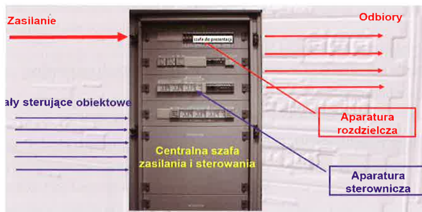
Rysunek nr 5. Powiązanie zasilania i sterowania stosowane wcześniej i obecnie.
